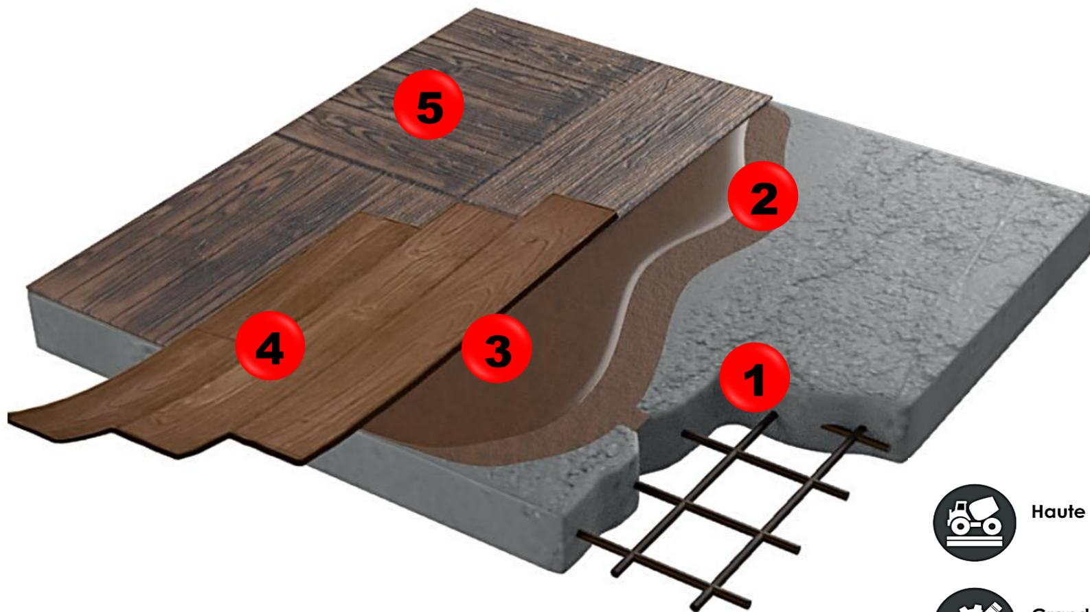
1 - Dalle en Béton fibré et ferrillé (Epaisseur 12/15cm).
